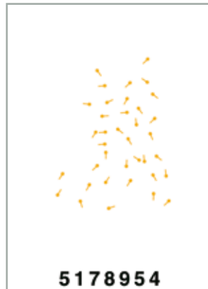
Die Minutien werden über einen Algorithmus in eine Zahlenkolonne umgewandelt. Es werden keine Bilder der Fingerabdrücke, sondern reine Zahlenkolonnen abgespeichert.
