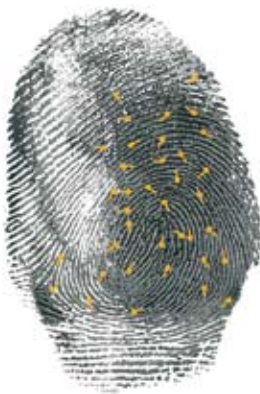
Digitales Bild eines Fingerabdrucks mit den vom System erkannten und verwendeten Minutien.
