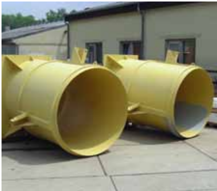
Mischersilos werden mit dem Werkstoff KERAFLEX ausgekleidet
