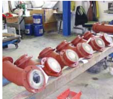
Bei Stahlrohren wird zur Auskleidung der Werkstoff ABRESIST/KALCOR eingesetzt
